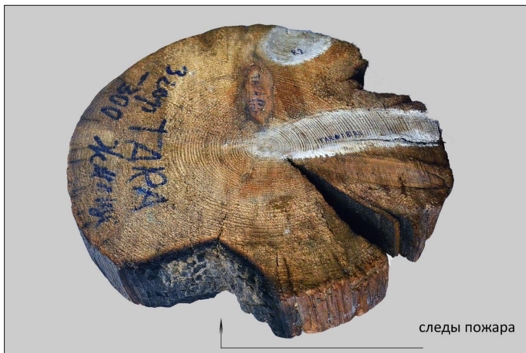
Рисунок 9. Образец tar18 из конструкции Тарской усадьбы со следами пожарных воздействий (фотография автора).
