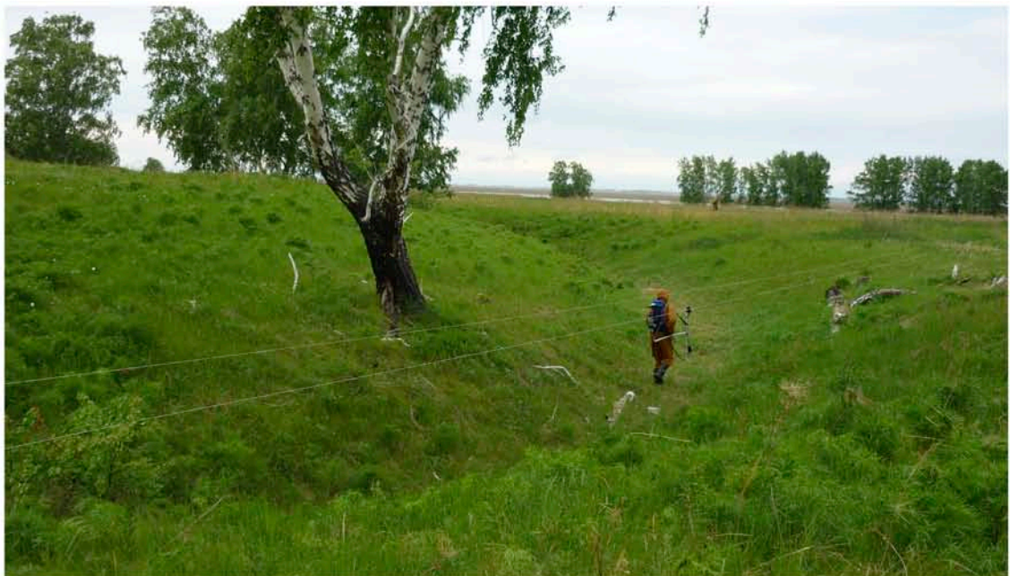
Рис. 74. Результаты магнитной съемки кургана № 2 памятника Белая Грива. а - карта аномального магнитного поля, построенная по данным измерений на высоте 0,5 метра [по: Дядьков, Позднякова, 2017, рис. 5]; б - процесс магнитной съемки, вид с юго-востока.
